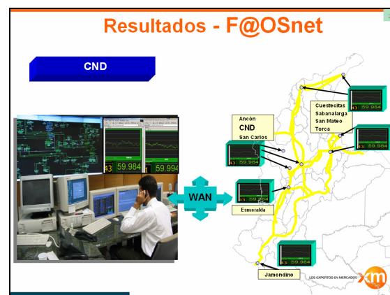
FIG 3. Red de monitoreo de frecuencia y caracterización de oscilaciones, F@OSnet
