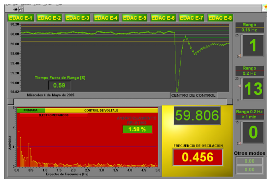
FIG 7. Caracterización de oscilaciones de potencia a partir del software para medición de frecuencia y detección de oscilaciones
