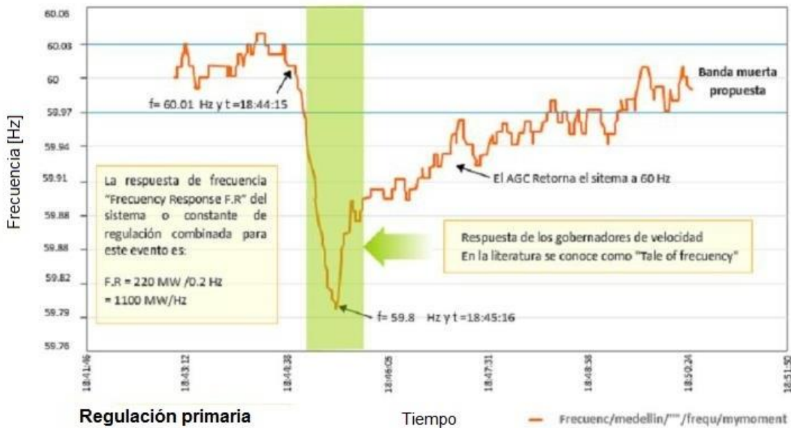
Evolución de la frecuencia ante la pérdida de 220 MW en Guavio
